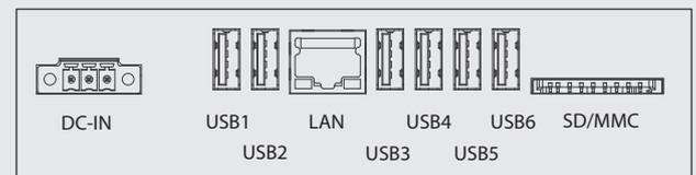
Der IM-986 Panel PC ist lauffähig mit den Windows-Betriebssystemen XP, CE, 2000, sowie auf Linux. Über die LAN-Schnittstelle kann der PC an ein Netzwerk angeschlossen werden und durch die 6 USB-Anschlüsse ist es z.B. nicht mehr notwendig, externe Hardware wie einen USB-Hub anzuschließen.
